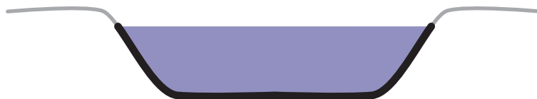
Fig. 2 : le rayon hydraulique d'un canal ou d'une rivière est le rapport entre la section mouillée (en couleur) et le périmètre mouillé (en noir)
